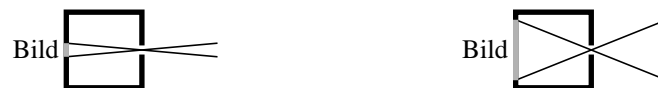
Abb. 4: Im Ruhssystem der bewegten Kamera (links, mit dem in Abb. 3 konstruierten Bild) kommen die Lichtstrahlen steiler von vorn als im Bezugssystem der ruhenden Kamera (rechts, Ausschnitt aus Abb. 2).
